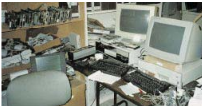
Phase 3-D-RUDAK-Software-Entwicklung – Blick ins Labor von Dale, N3EUA. Hier werden künftige Funktionsabläufe untersucht. Die beiden Laptops stellen Daten des simulierten Downlinks dar. Der linke PC dient u.a. der EPROM-Programmierung, der rechte überwacht über einen Adapter den CAN-Bus. Foto: KB5FU
