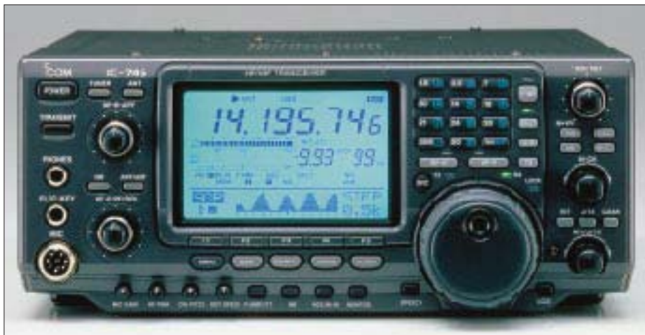
Die Frontansicht des IC-746 wird wie bei seinen Brüdern IC-706 und IC-756 durch das große und helle Display bestimmt, das hier im unteren Teil eine zweizeilige Punktmatrix oder das Spektroskop darstellen kann. Foto: Icom
