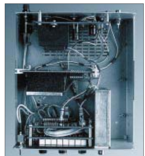
Bild 20: Blick von oben. Vorn die Einheit Acrylscheibe – Display – Zähler. In der Mitte die Steuerung mit Thermostathäube. An der Rückseite die Stromversorgung. Foto: Autor
