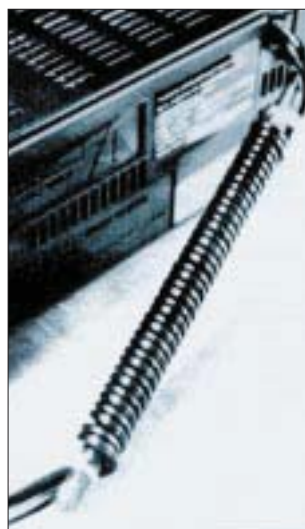
Bild 5: Ein Ferritstab läßt sich besonders gut bei einem Spiral-Tastaturkabel einsetzen.
