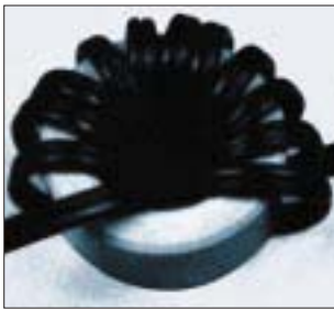
Bild 4: Über einen Ferritringkern gewickeltes Netzkabel. Die Enden der „Spule“ wurden mit Kabelbindern gesichert.
