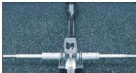
Bild 2: Das isoliert gehaltene Mittelstück des Strahlers
