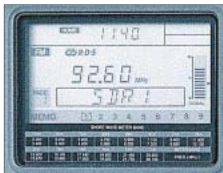
Auch auf UKW bietet der ATS 909 mit Stereo und RDS einschließlich Zeitauswertung Ungewöhnliches. Foto: Autor
