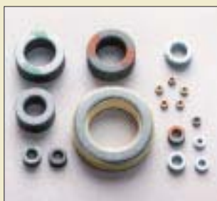
In der Bastelkiste schlummern oft noch Ringkerne, die wegen unbekannter Daten keine Verwendung finden können. Mit Hilfe eines SWR-Analysators kann man sie ausmessen. Foto: DF6SJ
